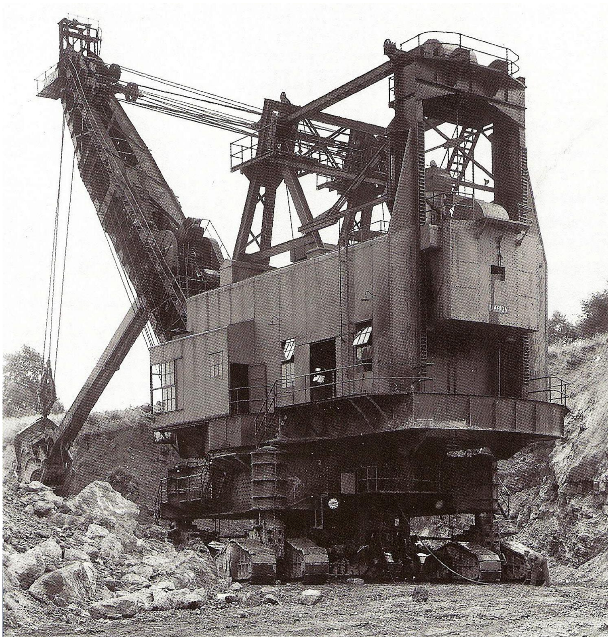
Obr. 25 Marion Model 5560 s protivyvažovacím systémom [1]
