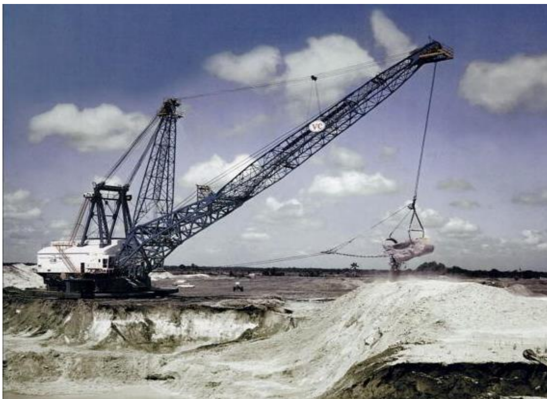
Obr. 55 Unikátne dvojdielne rameno na rýpadle 1250-W [2]
