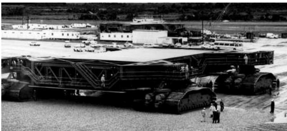
Obr. 48 Transportér od Marion, na ten sa pripevnila konštrukcia, ktorá držala raketu [24]
