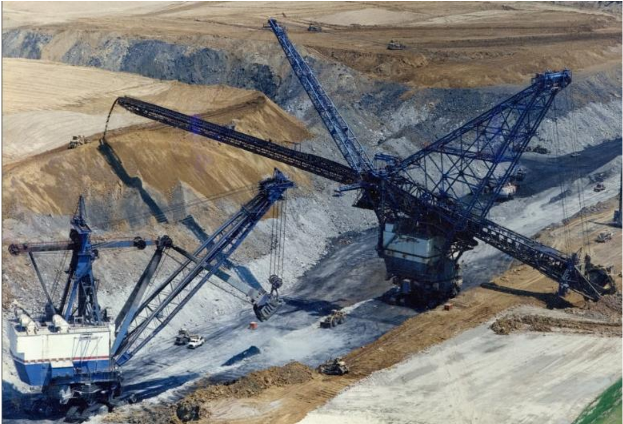
Obr. 49 Marion 5860 s nadstavbou kolesového rýpadla, s ním Marion 5900. Pôvodne pracovalo kolesové rýpadlo s Marion 6360 no po jeho nehode ho bolo treba nahradiť. Captain baňa, rok 2014 [54]
