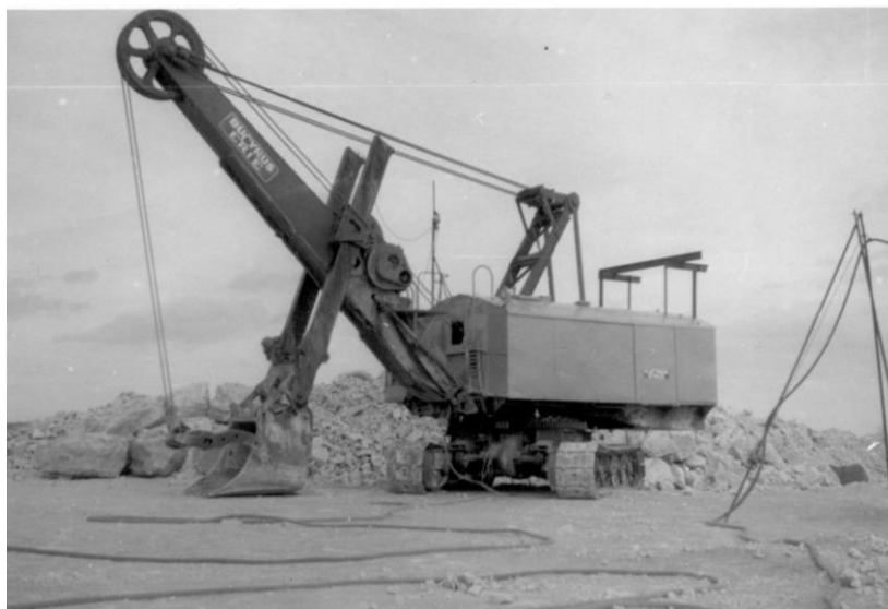
Obr. 42 Bucyrus Erie 150-B, vynovené malé nakladacie rýpadlo[2]
