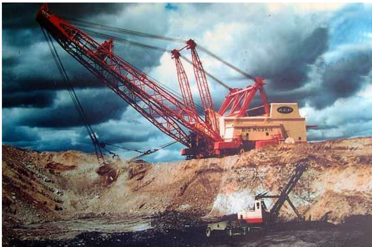
Obr. 59 Najväčšie lanové rýpadlo napĺňa svoju lopatu, na jeden takýto záber bolo schopné poňať 325 ton zeminy [62]
