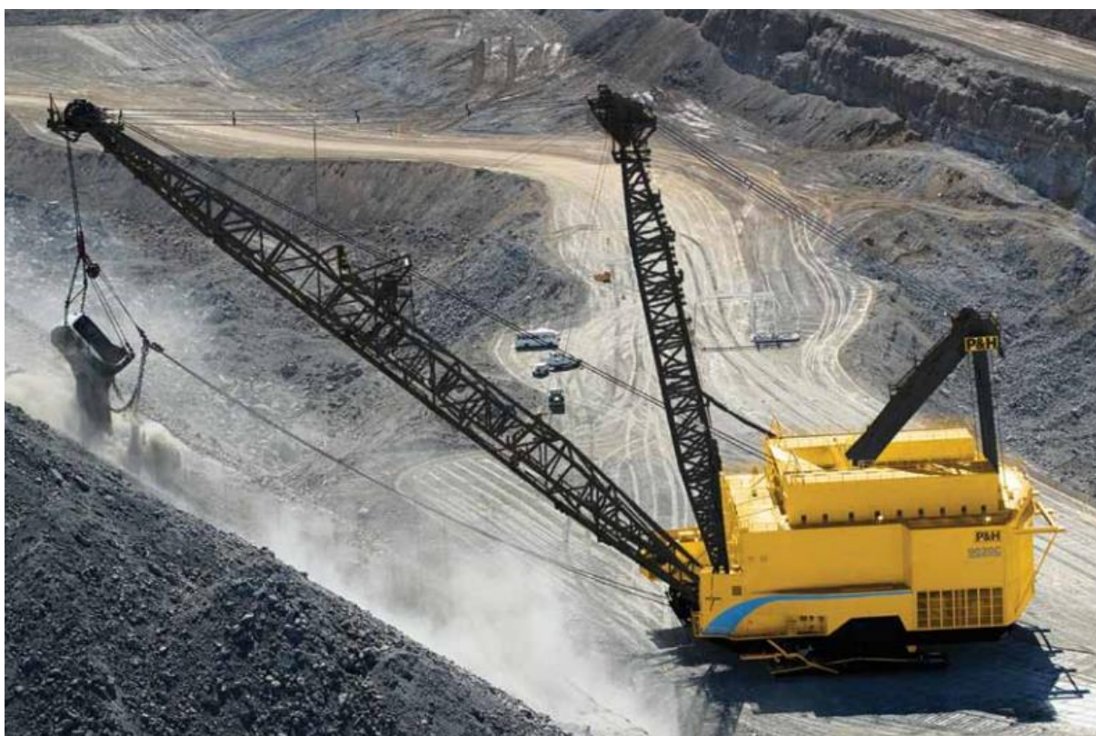
Obr. 62 Dnes najmodernejšie a najväčšie rýpadlo s vlečnou lopatou v ponuke P&H [65]
