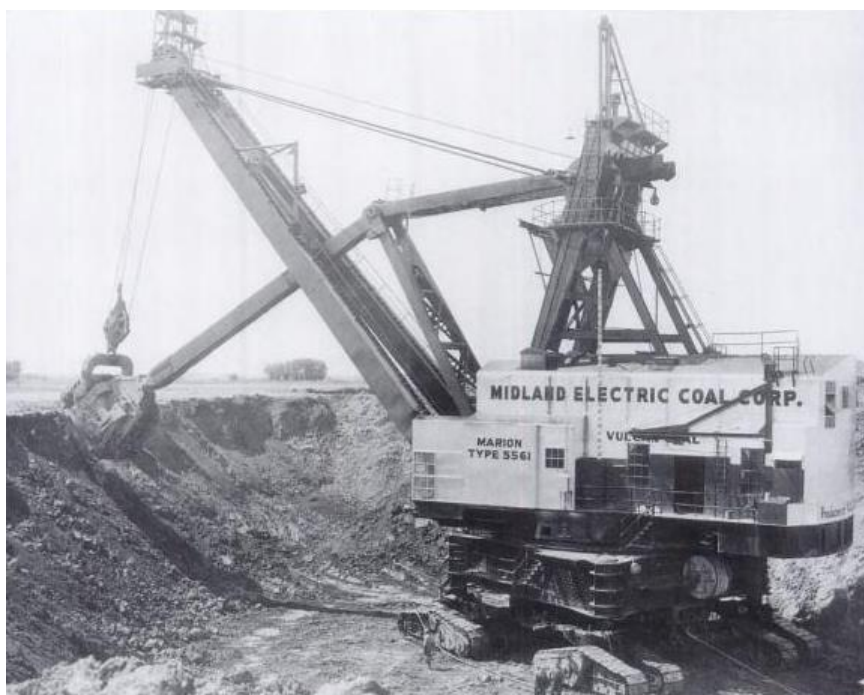
Obr. 40 Nový systém uchytenia násady je viditeľný v porovnaní so starším modelom [2]
