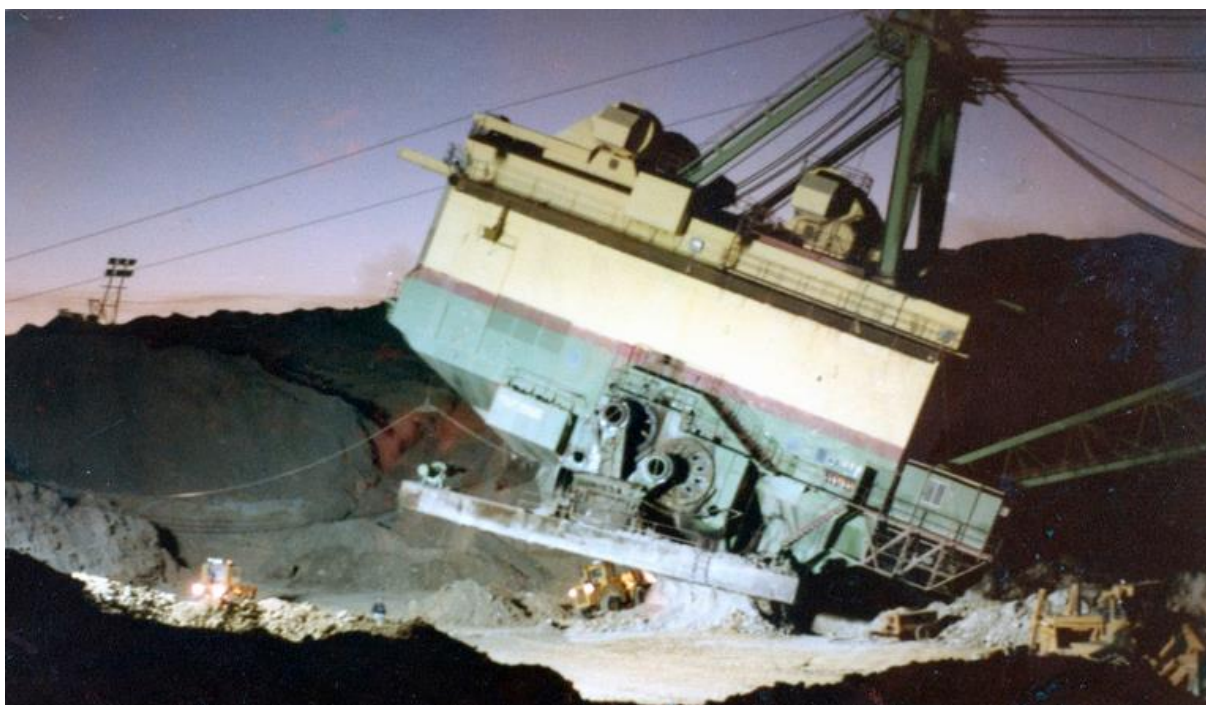
Obr. 58 Marion 8900 po nehode, rýpadlo sa zachytilo z oboch strán a zemina sa odkopala na rovinu, fotka zobrazuje posledný odkop zvyškov zeminy pod rýpadlom.[61]
