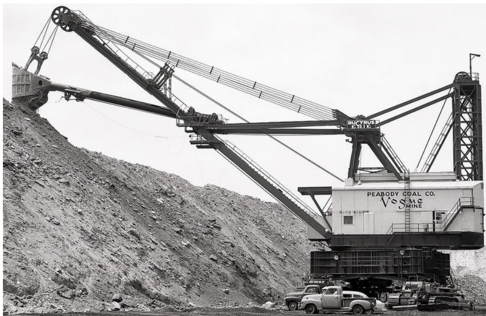
Obr. 41 Bucyrus Erie 1050-B z profilu, vyniká protivyvažovací systém [49]
