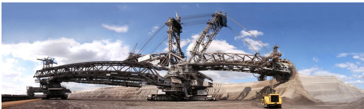
Obr. 69 Panoramatická fotografia zachytávajúca celé kolesové rýpadlo so všetkými časťami [72]
